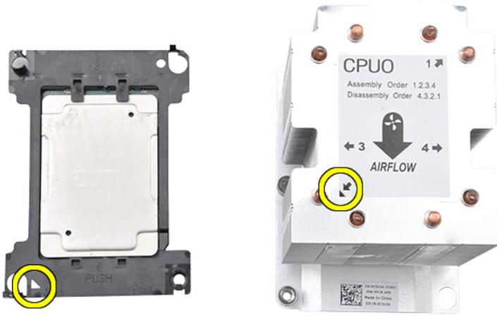
6 将处理器和托盘部件插入散热器，使托盘四角上的挂钩锁定到散热器的开口。
