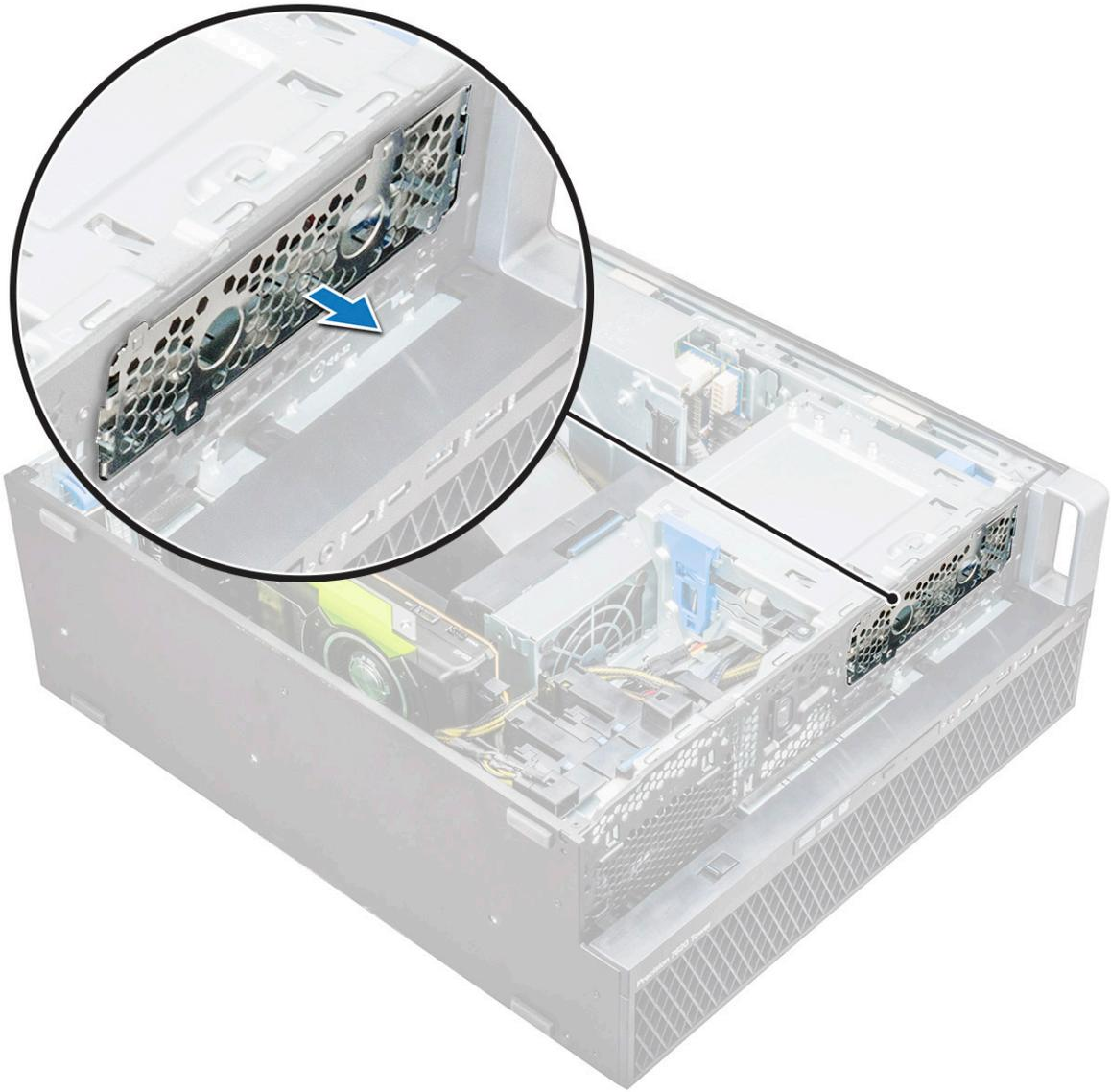
b 拧下将支架固定至机箱的五颗螺钉[1,2]。
